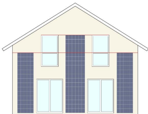
III. 34 Les différentes parties de l'installation sont alignées par rapport aux éléments existants de la façade et présentent une harmonie de forme. Le rendu global est harmonieux.
