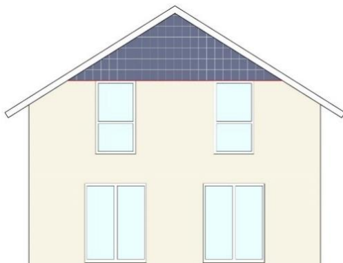
III. 28 L'installation recouvre entièrement le pignon concerné.
