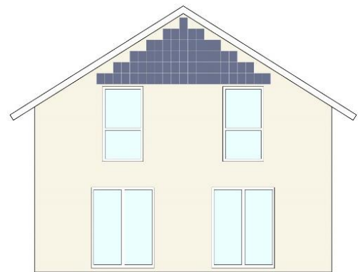
III. 29 Les modules de l'installation sont posés en escalier et ne recouvrent pas entièrement le pignon concerné.
