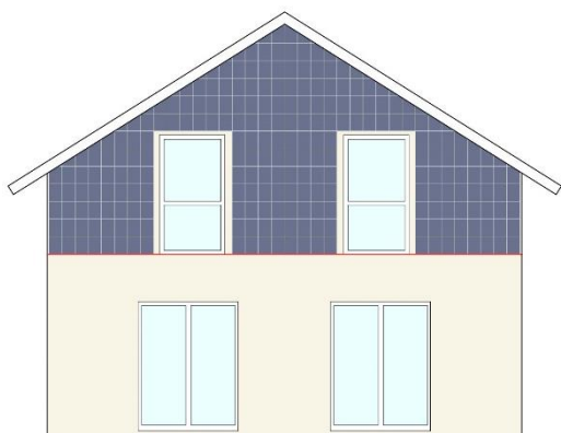
III. 36 Une partie de l'installation recouvre entièrement le pignon. Elle forme un ensemble harmonieux avec la partie rectangulaire de l'installation qui se trouve en-dessous. La partie basse de l'installation est alignée par rapport aux bordures inférieures des fenêtres. Le rendu global est harmonieux.
