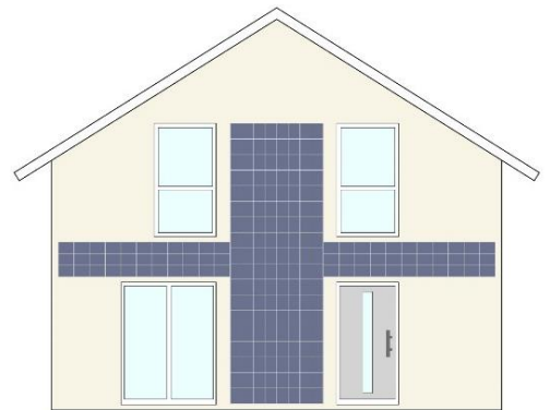
III. 31 La teinte de l'installation n'est pas similaire à celle de la façade.
