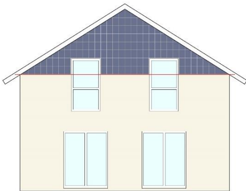
III. 26 L'installation recouvre entièrement le pignon concerné.
