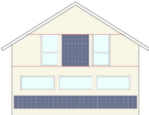
III. 32 Les différentes parties de l'installation sont alignées par rapport aux éléments de façade existants et sont centrées, mais elles ne sont pas disposées de manière régulière. Le rendu global est tout de même harmonieux.
